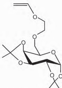
Figure 11. Formule du monomère 1,2:3,4-di- O -isopropylidene-6- O -(2-vinyloxyethyl)- \alpha -D-galactopyranose (noté GVE)
